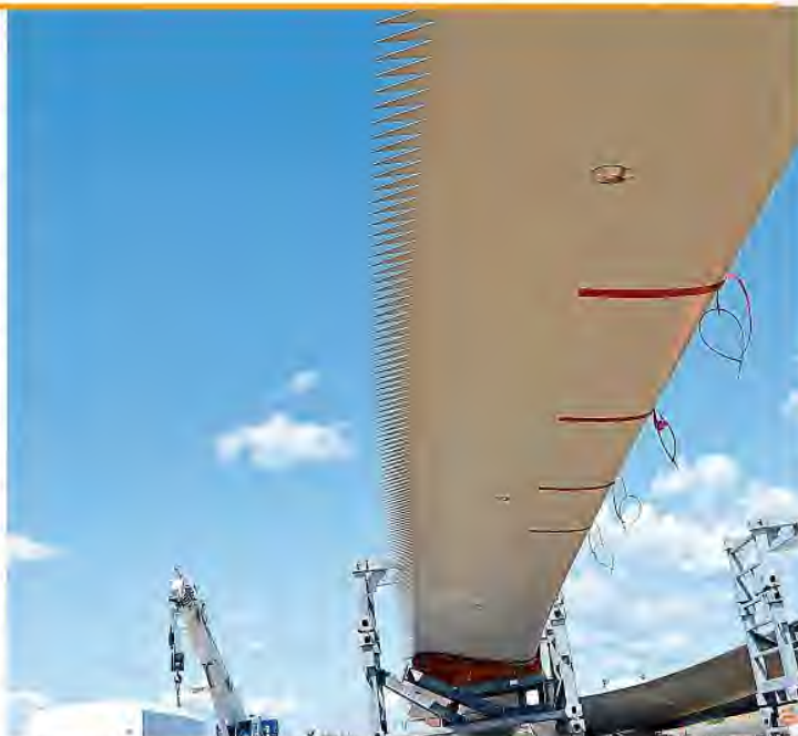
Sur près de la moitié de leur longueur, l'arête des pales est dotée de "peignes", sorte de motif en dents de scie, ce qui réduit le bruit qu'elle génère.
