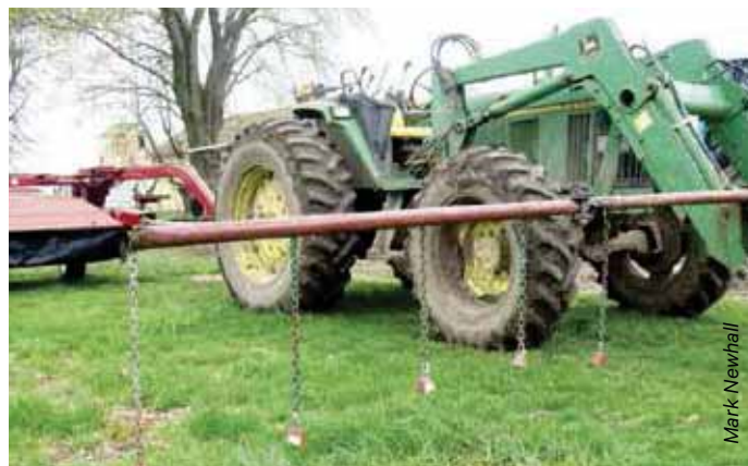
Figure 4.17 La barre d'effarouchement. Les chaînes doivent toucher au sol pour que la barre soit efficace. L'utilisation de cloches n'est pas nécessaire pour l'herpétofaune, bien qu'elle peut l'être pour d'autres espèces animales.
